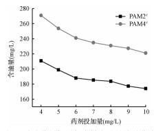
图 2 破乳药剂加量与水样含油量关系曲线
