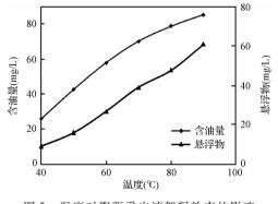
图 5 温度对聚驱采出液絮凝效率的影响
