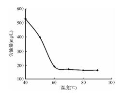
图 3 温度对聚驱采出液破乳效率的影响
