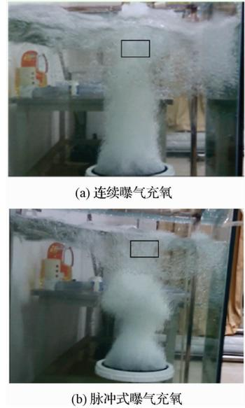
图 4 连续曝气充氧和脉冲曝气充氧实验对比
