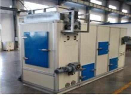
箱式系统设计，适用于板框压滤机出料，减重量75%以上
