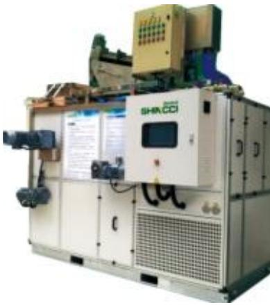
污泥脱水、干化一体化设计，污泥可从含水率 99% 直接减量至 10%
